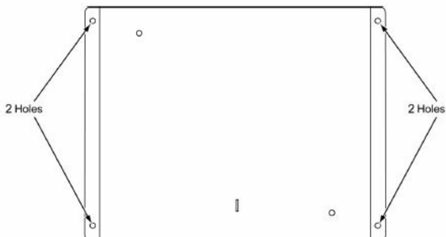
图 3-11 用螺栓固定 CHS 底座
