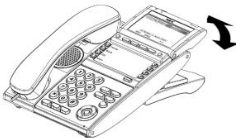
图 5-21 调整 LCD 的角度
